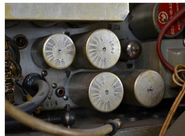
Fig. 3 : Condensateurs à tubes suspectés de contenir des PCB, projecteur Micron 18, daté de 1958 ©A.Lefebvre, HE-Arc CR, 2019
