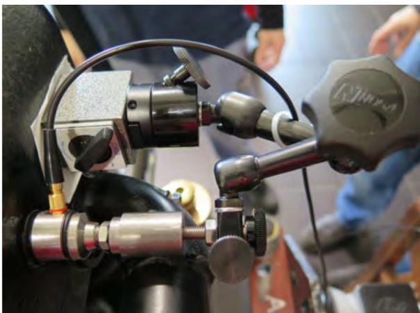
Fig. 2 : Capteur d'émission acoustique fixé sur le moteur test ©MNAM-HECR, 2019
