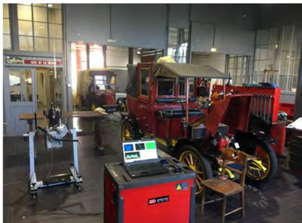
Fig. 1 : Test d'émission acoustique en cours sur le moteur de la Renault AG1 «Taxi de la Marne» (Inv.2209) ©MNAM, Chalançon, 2019
