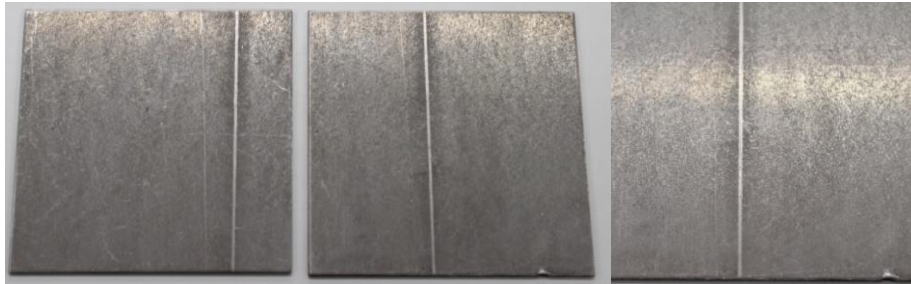
Figures 30 et 31 : Vue d'ensemble de deux coupons en acier et vue de détail des défauts
