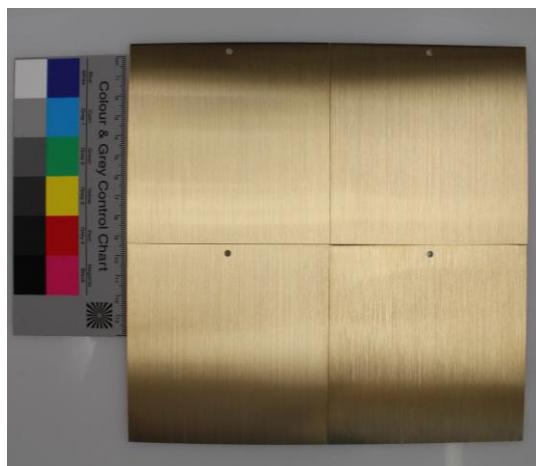
Figure 100 : Vue d'ensemble des plaques nettoyées par projection d'abrasif végétal et témoin non nettoyé en bas à droite
