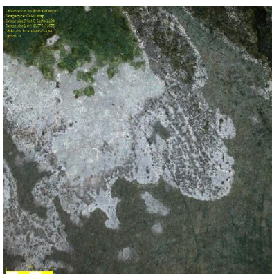
Figure 65 : nettoyage cryogénique, 4 bar : les produits gras les moins adhérents sont désolidarisés localement
