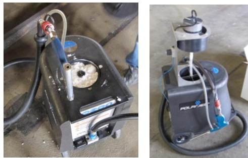
Figures 60 et 61 : Polarjet1600 employé pour le nettoyage cryogénique / modèle employé pour la projection d'abrasif végétal
