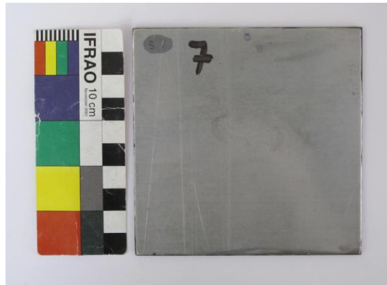
Figure 176 : Vue du revers de l'éprouvette en acier S7, marquage au vernis et zone poinçonnée protégée
