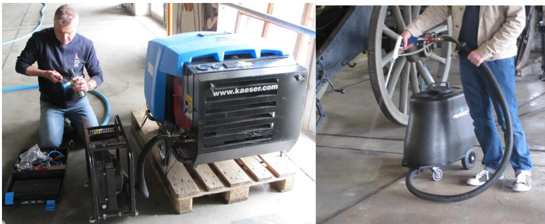
Figures 52 et 53 : Mise en place du dispositif de nettoyage (manomètre, déshumidificateur et compresseur) / Polarjet 1600® en cours d'utilisation
