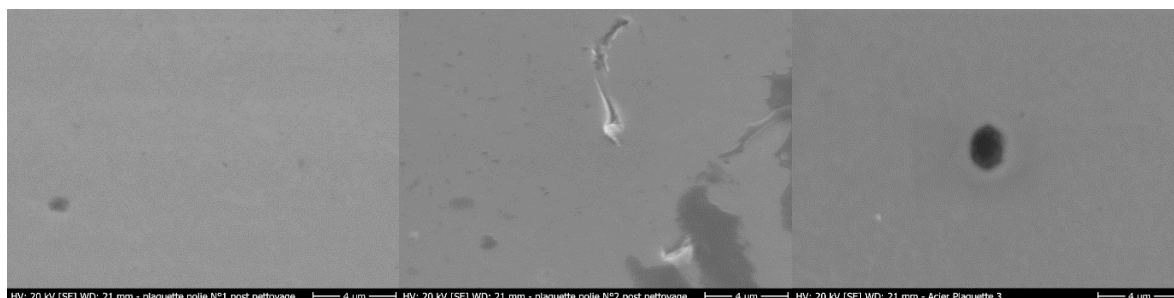
Figures 172-174 : Vue de détail après nettoyage cryogénique/après nettoyage par projection d'abrasif végétal et témoin non nettoyé (4 µm)
