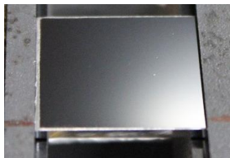
Figure 95 : Coupon acier poli miroir après nettoyage cryogénique (passage de la buse 90°)
