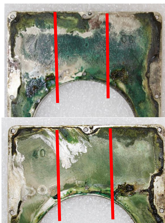
Figures 68 et 69 : Plaques n°36 et n°29 : Résultats obtenus au nettoyage cryogénique, trois pressions différentes, de gauche à droite par segment : 4 / 3 / 1,5 bar
