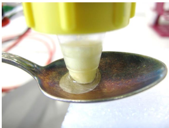
Fig. 44 : Nettoyage de la surface de la cuillère avec le pinceau aux environs de -1800\text{mV/C. vitreux} . Noter le non reternissement de la surface du métal au cours du nettoyage.
