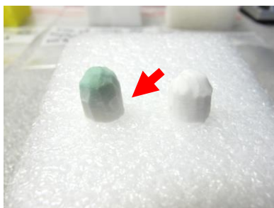
Fig. 107 : Aspect de surface d'un tampon PVFM AION® usagé lors de la 1 ère polarisation cathodique (voltammétrie suivie de chrono-ampérométries) menée sur un des éléments de la manche du bras reliquaire de saint Bernard, en comparaison de l'aspect d'un tampon simplement rincé (a) et spectres de fluorescence X du tampon rincé et du tampon PVFM AION® après polarisation (b).
