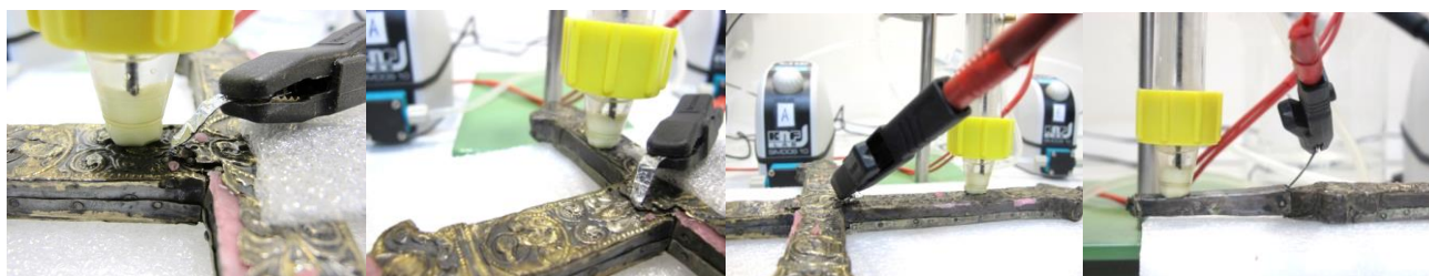
Fig. 64 : Positionnement du pinceau électrolytique pour la définition des paramètres de traitement sur les plaques 1 à 4 de la croix reliquaire de la Vraie croix.
