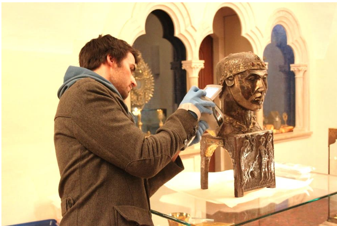
Fig. 10 : Analyse élémentaire du chef reliquaire de saint Candide avec l'analyseur ThermoFischer®. L'examen est mené dans l'ancienne salle d'exposition du trésor de l'abbaye de Saint-Maurice.
