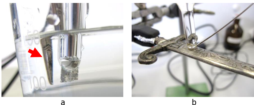
Fig. 18 : Polarisation cathodique au niveau de la pointe de l'épée immergée dans \text{NaNO}_3 agité (a) et polarisation cathodique localisée avec goutte (sans rallonge) sur la lame de la même épée (b).
