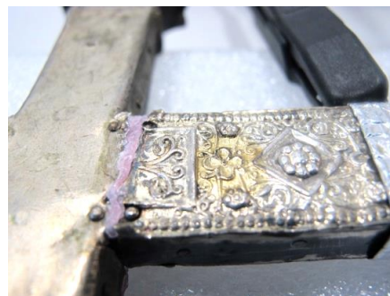
Fig. 72 : Définition des paramètres de traitement avec le pinceau électrolytique sur la plaque 5 de la croix reliquaire de la Vraie croix. Tracé de voltammétrie linéaire anodique porté à 1000mV/C. vitreux et zone nettoyée (à droite ci-dessus).
