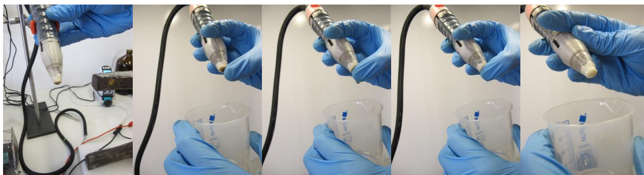
Fig. 181 : Protocole de nettoyage de la surface du tampon par compressions successives.
