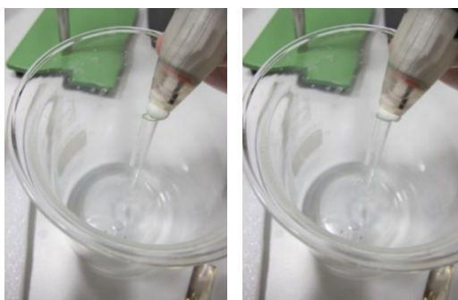
Fig. 182 : Rinçage du tampon par pression contre le tube d'un entonnoir en verre renversé et placé dans un bécher.
