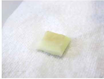
Fig. 94 : Aspect de la face extérieure du tampon PVA ADW® au terme de la polarisation cathodique sur la plaque 5 de la croix reliquaire de la Vraie croix et après rinçage.
