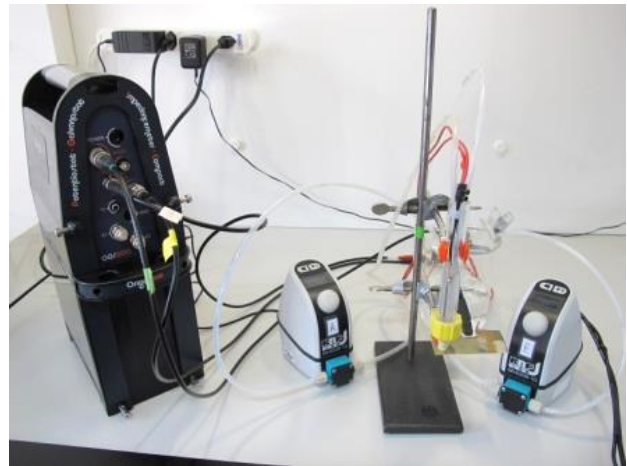
Fig. 47 : Nouveau système de circulation de l'électrolyte : emploi de deux pompes à membrane en circuit fermé.
