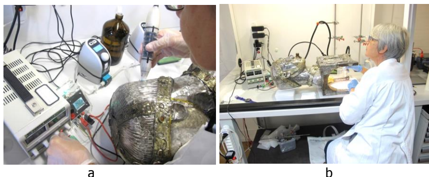
Figure 185 : Modification de la tension de cellule au niveau du générateur de tension/courant afin d'appliquer un potentiel cathodique optimal (LED verte) (a) et nettoyage « aveugle » (b). Le non déclenchement de la LED de la cloche (couleur rouge) ne signifie pas que le potentiel appliqué est optimal. Il peut être inférieur au domaine optimal, la LED du système de contrôle étant bleue.
