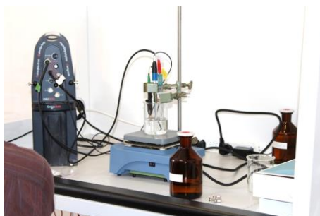
Fig. 11 : Montage pour la définition des paramètres de traitement, mode par immersion.
