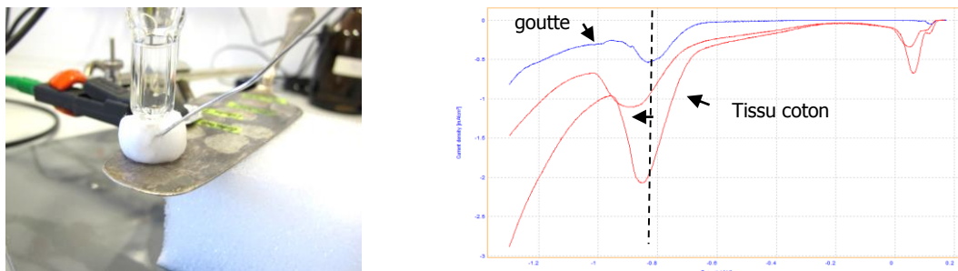
Fig. 39 : Comparaison entre les tracés voltammétriques linéaires cathodiques réalisés en présence d'un tampon en coton ouate ou avec la méthode à la goutte, ER – Ag-AgCl dans sa rallonge.
