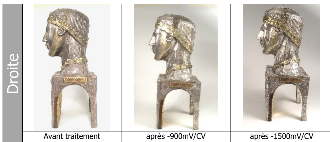
Figure 184 : Aspect de surface des plaques des 4 côtés du chef reliquaire au cours de son nettoyage électrolytique à différents potentiels.
