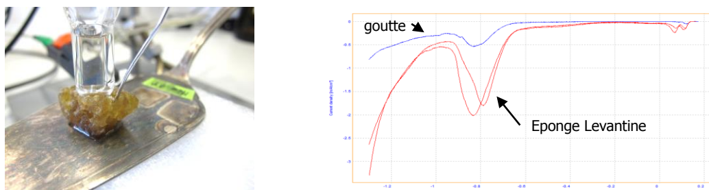
Fig. 36 : Comparaison entre les tracés voltammétriques linéaires cathodiques réalisés en présence d'un tampon en éponge Levantine ou avec la méthode à la goutte, ER : Ag-AgCl dans sa rallonge.
