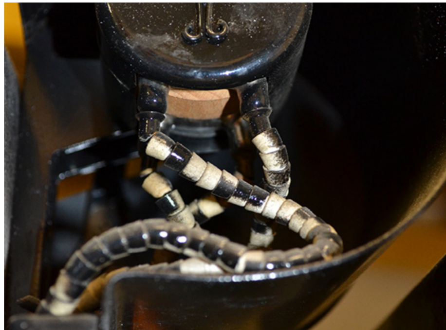
Fig. 2 : Interrupteur à mercure de sécurité, projecteur Ernemann IV, daté de 1937 ©A.Lefebvre, HE-Arc CR, 2019
