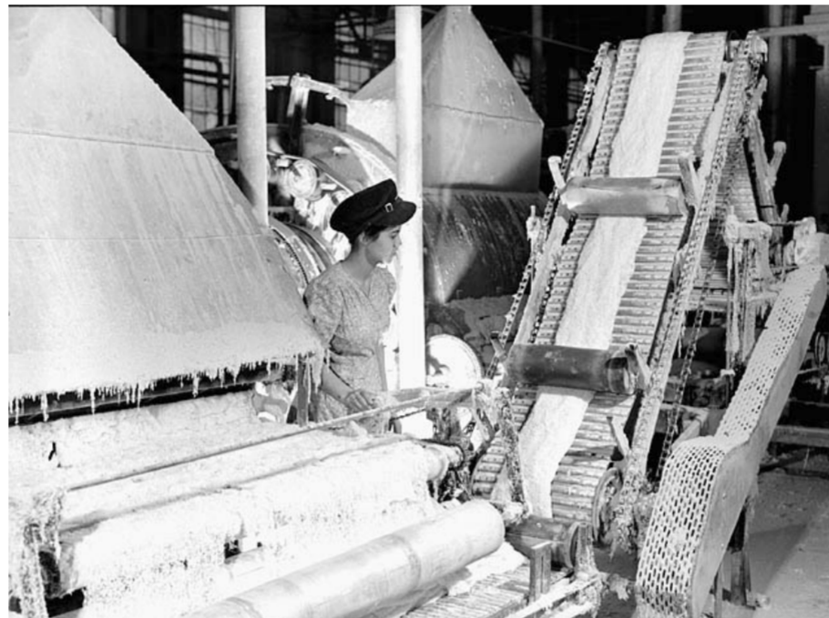
Fig. 2 : Machine à carder la fibre d'amiante, usine Johns-Manville à Asbestos (Québec), 1944, Harry Rowed ©Office national du film du Canada. Photothèque/ Bibliothèque et Archives Canada
