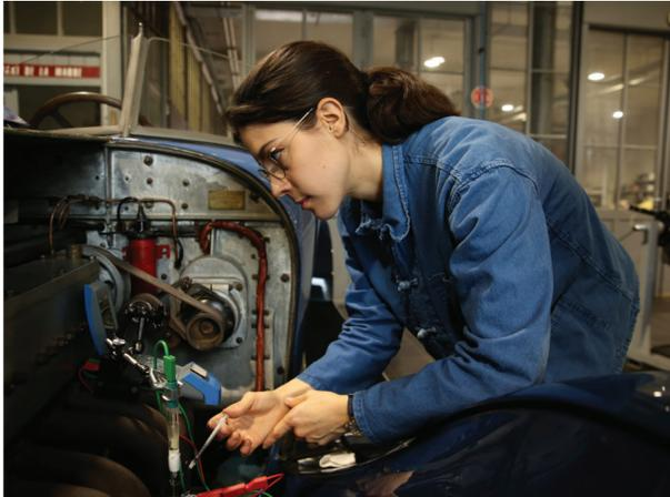
Fig. 2 : Analyse in situ DiscoveryMat sur la Bugatti Type 30 (Inv 5067) après optimisation de sa base de données pour l'analyse des alliages d'aluminium ©Xavier Denombel 2020
