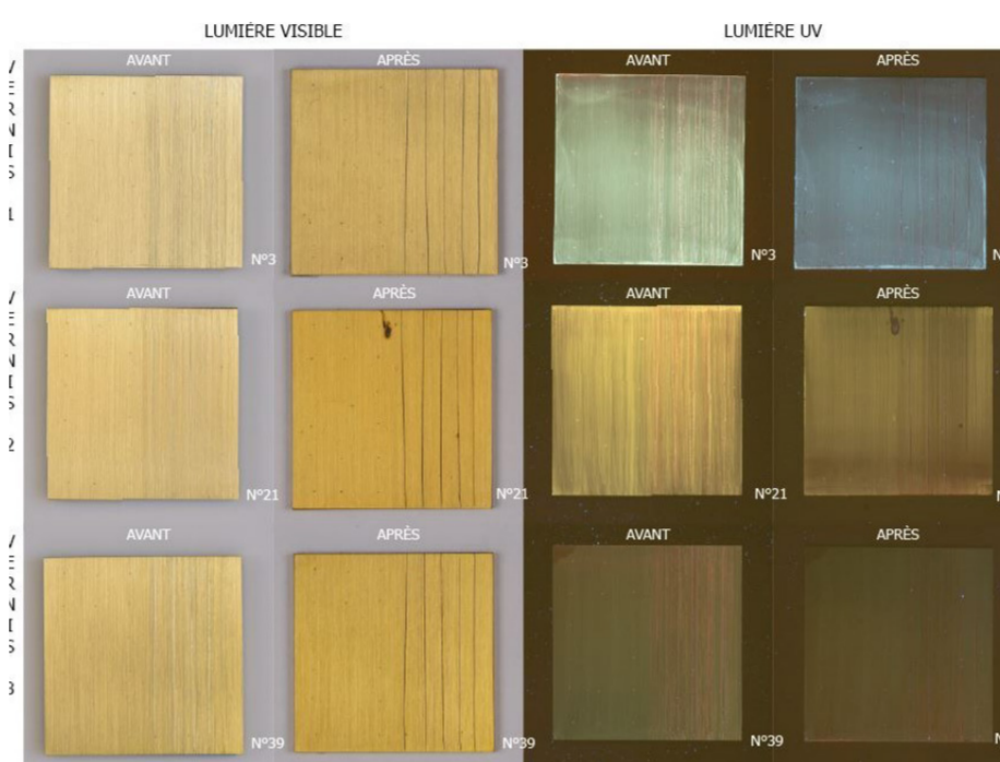
Fig. 2 : Photographies sous lumière visible et UV de trois coupons recouverts chacun d'un vernis gomme-laque différent. Vues avant et après vieillissement thermochimique et hydrolytique ©M.Petit, HE-Arc CR, 2020
