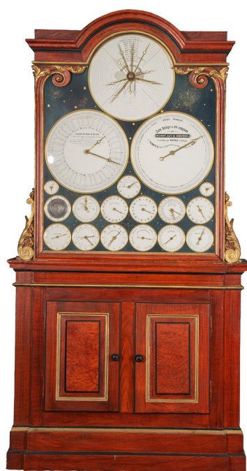
Fig. 1 : Horloge astronomique à 23 indications, datant de 1849, réalisée par Delvart, et exécutée par Potez ©Z.Snijders, HE-Arc CR & MIH, 2021
