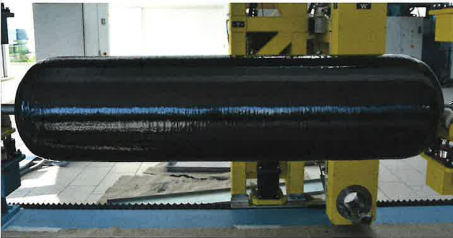
Réservoir en fibres de carbone réalisé par la société MaHyTec selon le procédé de fabrication de l'enroulement filamentaire, une technologie et un savoir-faire transférés du DMA vers MaHyTec lors de la création de l'entreprise.
