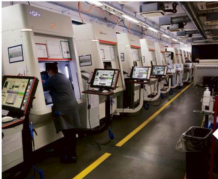
Chez DM Surfaces, les machines laser tournent en continu pour décorer et graver des composants.
