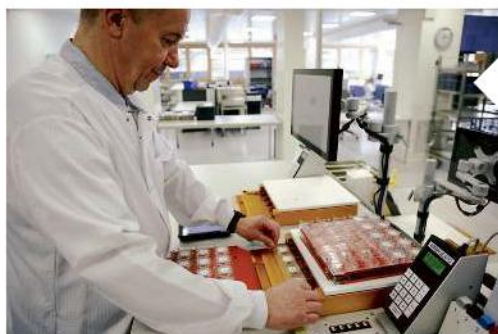
Au COSC, les mouvements sont rangés dans différentes positions pour mesurer l'impact de la gravité sur leur justesse.
