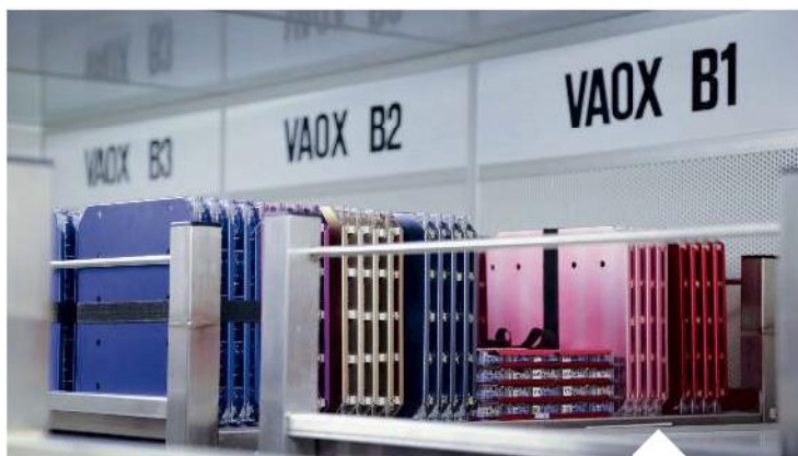
Au COSC, les mouvements sont rangés dans différentes positions pour mesurer l'impact de la gravité sur leur justesse.
