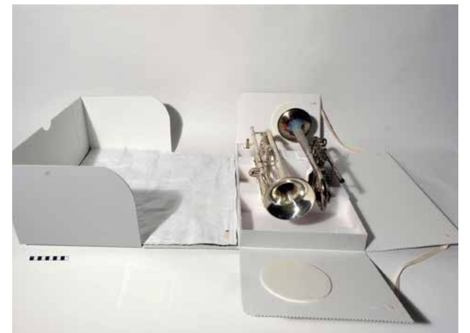
Fig. 3 : Concept de conditionnement avec parois rabattables conçu pour intégrer les supports des objets et le Pacific Silvercloth® doublé de Tyvek® (logé à gauche dans le couvercle). © Z. Meystre, HE-Arc CR, HMB, 2022
