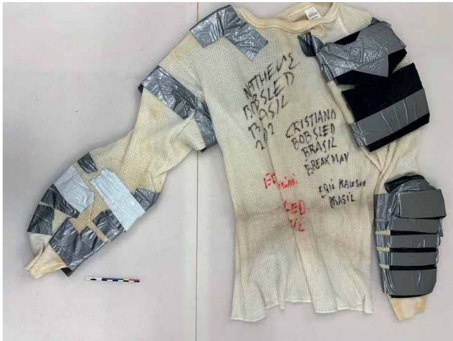
Fig. 2 : Exemple d'ajout de renforcements en mousse sur un maillot de bobsleigh. ©Sidonie Pradervand, HE-Arc CR, 2022
