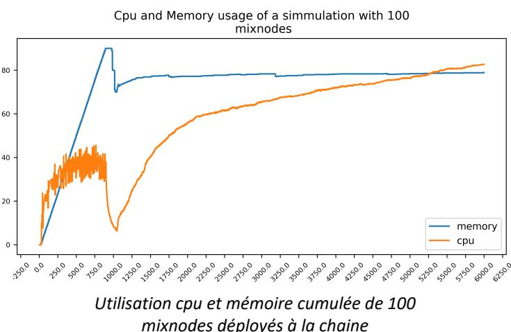
La figure ci-dessus montre la consommation de ressources de 100 instances d'une composante du réseau Nym déployée sur le simulateur.
