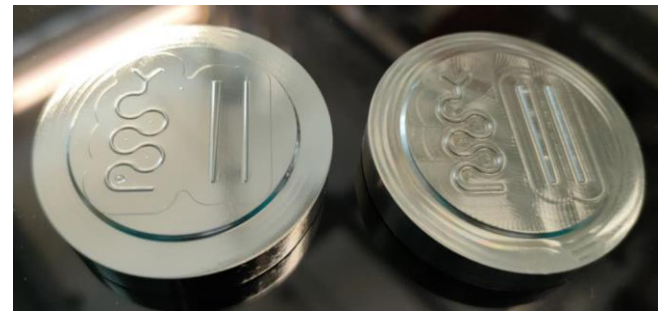
Moule en acier 316L avant (à droite) et après (à gauche) électro-polissage
