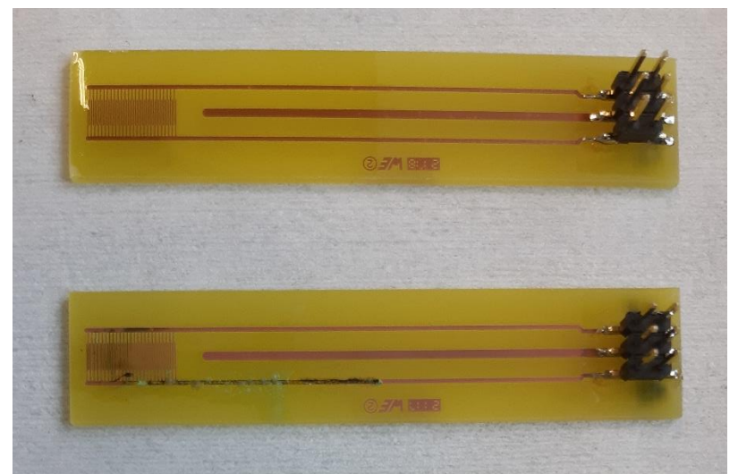
Comparaison à l'issue du test SIR entre un échantillon avec une couche de PDMS (haut) et un sans couche de PDMS (bas)
