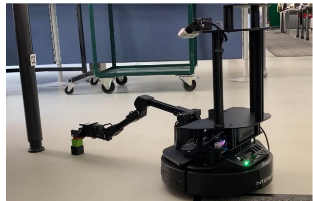
Construction de la tour par le robot
