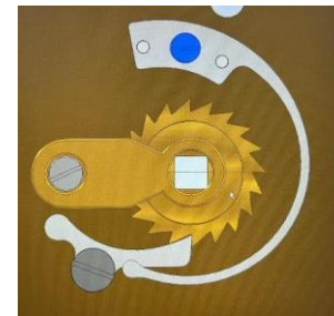
Fig. 7 : Nouveau système d'armage du barillet
