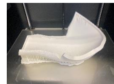
Impression partie supérieure (PLA)
