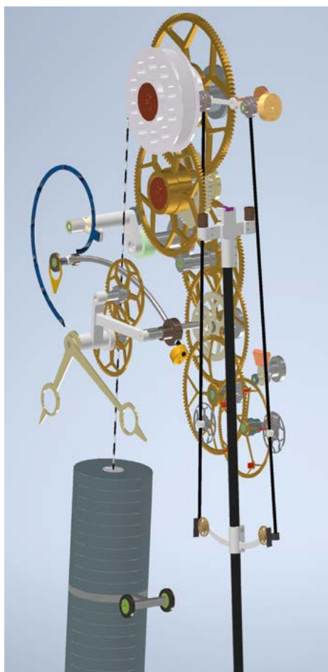
Vue d'ensemble du mécanisme de l'horloge avec le poids moteur et le pendule; en bleu, la pièce qui déclenche l'entrechoquement des tiges d'acier.
