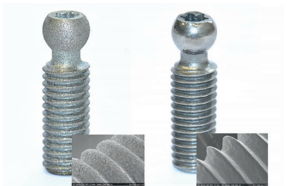
■ Fig. 3: Effet du polissage électrochimique sur l'état de surface.
