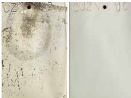
Fig. 1 : Résultat du test de vieillissement accéléré : interactions survenues sur la surface du coupon en laiton argenté lors de contact direct avec le Pacific Silvercloth® (gauche) et surface non altérée d'un coupon similaire grâce à la présence d'une interface de Tyvek® (droite). ©Z. Meystre, HE-Arc CR, 2022
