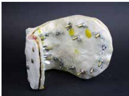
Fig. 2 : Moule par estampage obtenu grâce à la méthode de stratification d'une des feuilles basses du lustre. ©SZSNM et Julie Vuignier, HE-Arc CR, 2022
