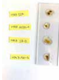
Fig. 2 : Spot test au chlorure de fer sur quatre échantillons de cuir du MAZ. ©HE-Arc CR, 2022
