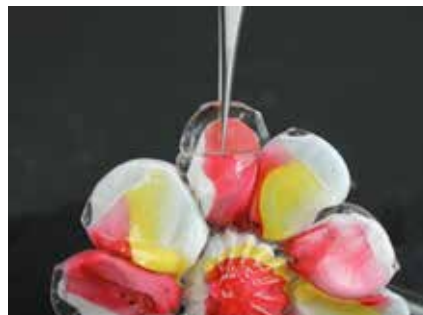
Fig. 3 : Test de comblement détachable obtenu à l'aide de feuilles de résines époxy et Paraloid™ B72. ©SZSNM et Julie Vuignier, HE-Arc CR, 2022
