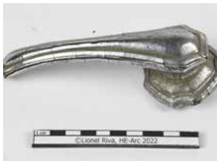
Fig. 2 : Poignée de porte des années 1930 altérée. © Lionel Riva, HE-Arc CR, 2022
