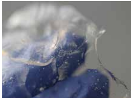
Fig. 2 : Gel d'agar à 4% dans l'eau déminéralisée utilisé pour le rinçage du carbonate de calcium ©HE-Arc CR, 2022
