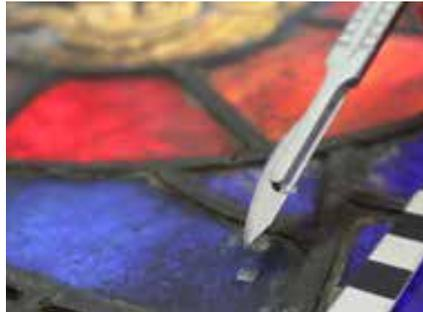
Fig. 2: Vitrail (V2), lumière transmise. Retrait des dépôts à l'aide d'un gel d'agar-agar. ©Dam. MahN, HE-Arc, 2023
