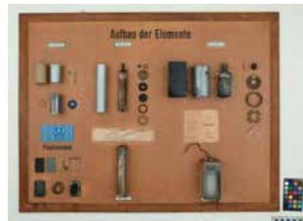
Fig. 3 : Planche présentant les divers types de piles sèches Leclanché de l'Armée suisse (années 1950-1960). Les piles prêtes à l'emploi, la pile de campagne et les éléments plats. Après traitement ©Noémie Nydegger, HE-Arc CR, 2023
