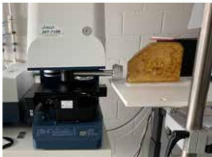
Fig. 2 : Analyse du revêtement sur les capuchons en plâtre des moules par FTIR. ©Camille Moos, SNM, HE-Arc, 2023
