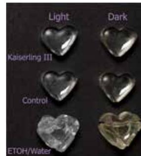
Fig. 3 : Échantillons dits « blocks » de HXTAL NYL-1 (époxyde) après 69 jours d'immersion, montrant la réaction entre le polymère et les fluides de conservation. ©HE-Arc CR, Museum Vrolik, A. Dupuis, 2023
