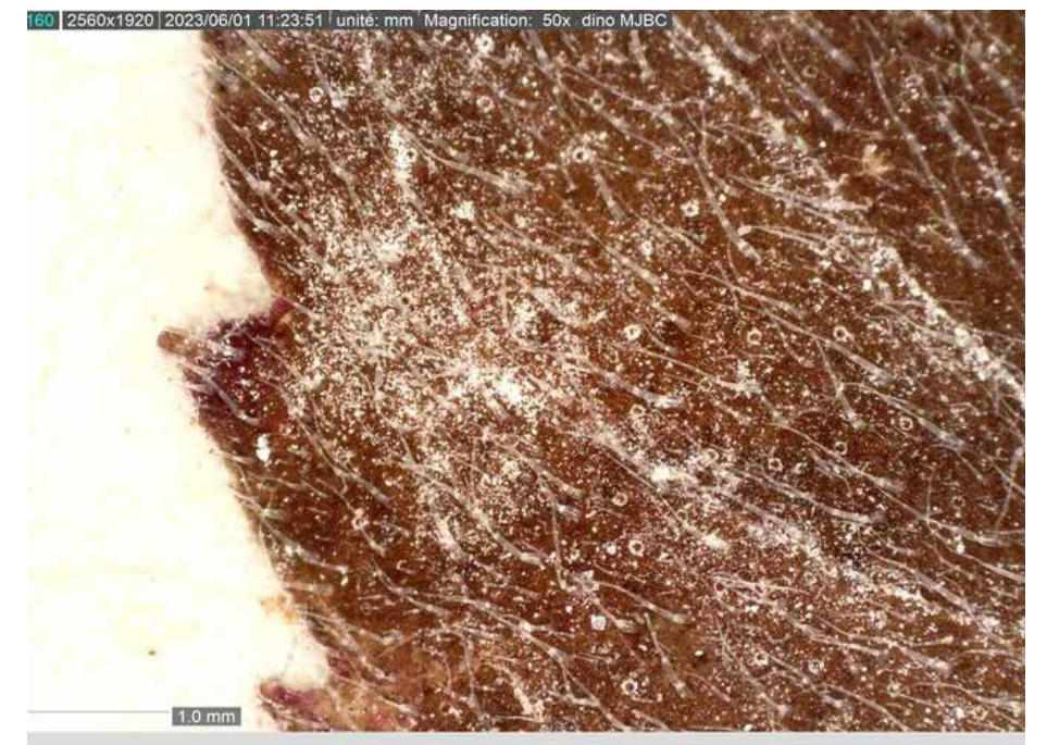
Fig. 3 : Traces de pulvéulence blanche sur un échantillon. ©HE-Arc, C. Gindroz, 2023
