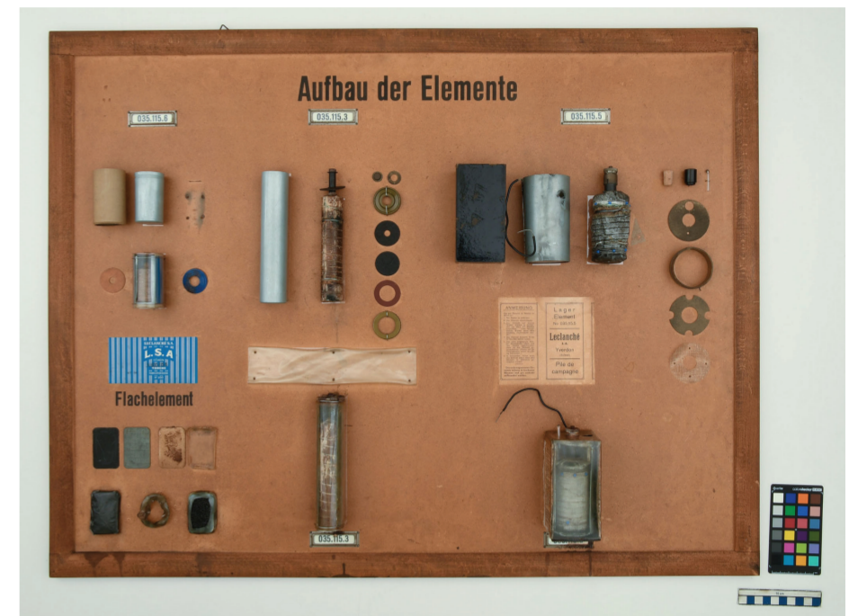
Fig. 3 : Planche présentant les divers types de piles sèches Leclanché de l'Armée suisse (années 1950-1960). Les piles prêtes à l'emploi, la pile de campagne et les éléments plats. Après traitement ©Noémie Nydegger, HE-Arc CR, 2023
