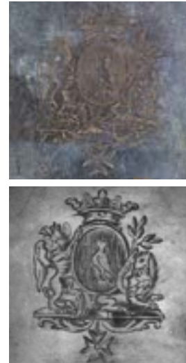
Fig. 1 : Impression visuelle sous 48 LEDs d'une armoirie sans modification des paramètres : le ternissement rend l'armoire difficilement lisible (cliché du haut) ; même impression visuelle avec nuances de gris et intensité matérielle élevée (cliché du bas) où les contours sont plus lisibles ©HE Arc CR Ra&D
