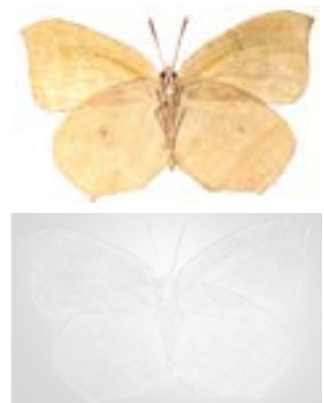
Fig. 2 : Impression visuelle sous 48 LEDs d'un papillon sans modification des paramètres (cliché du haut) et même impression visuelle avec modification des paramètres (cliché du bas), permettant de mettre en exergue l'épaisseur des ailes par rapport au corps dessiné ©HE Arc CR Ra&D
