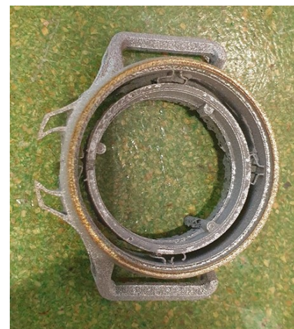
Impression 3D titane du premier prototype
