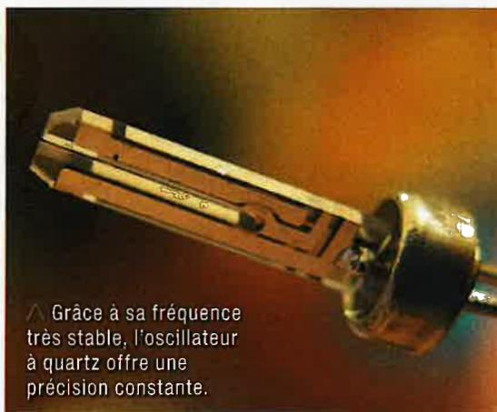
Grâce à sa fréquence très stable, l'oscillateur à quartz offre une précision constante.
