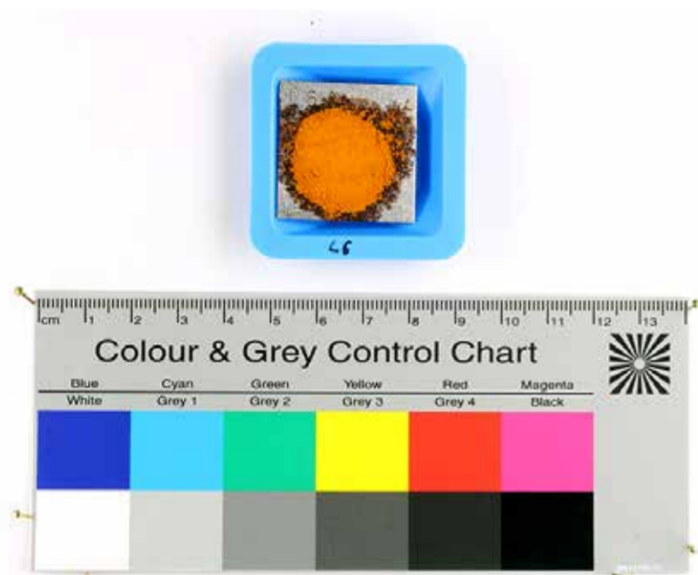
Fig. 1 : Photographie d'un échantillon (L6, lépidocrocite sur fer 60%HR). On observe la formation de corrosion en auréole autour de la poudre. ©HEARC2024, Julien Favre.
