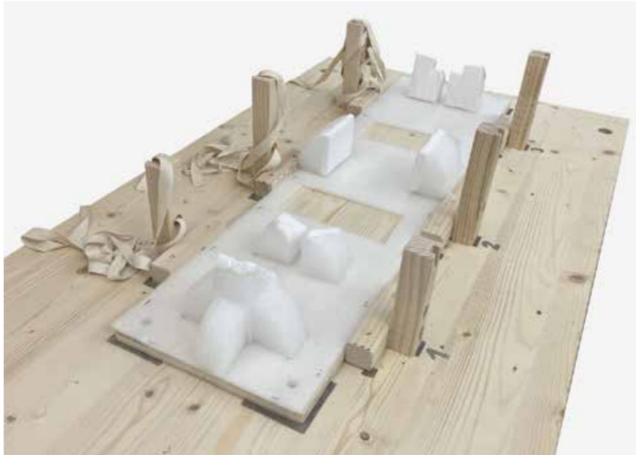
Fig. 2 : Système de calage en mousse et bois avec plaque coulissante et plaque fixe ©MahN, Plesu, HE-Arc CR, 2024.
