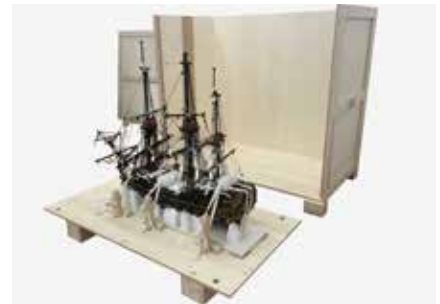
Fig. 3 : Caisse de conditionnement avec le fonctionnement de la plaque coulissante ©MahN, Plesu, HE-Arc CR, 2024.
