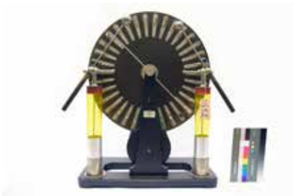
Fig. 1 : Machine électrostatique de Wimshurst, face avant, avant intervention, © HE-Arc CR, Louise Robert, 2024.
