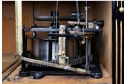
Fig. 2 : Vue du mécanisme à ressort, après restauration ©Léa Girardin, HE-Arc, 2024.
