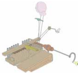
Fig. 2 : Schéma du mécanisme de la serinette situé dans le coffret de l'instrument. La tête, la main de l'automate et le serin étaient initialement mobiles. © HE-Arc, Z. Meystre, 2024.
