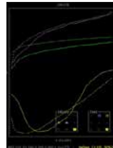
Fig. 3 : Proposition d'alliage, avec les tracés de la base de données (pointillés) et les tracés obtenus sur site (trait plein). © Nicolas Jeangros, HECR 2024.
