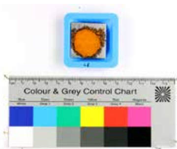
Fig. 1 : Photographie d'un échantillon (L6, lépidocrocite sur fer 60%HR). On observe la formation de corrosion en auréole autour de la poudre. ©HEARC2024, Julien Favre.
