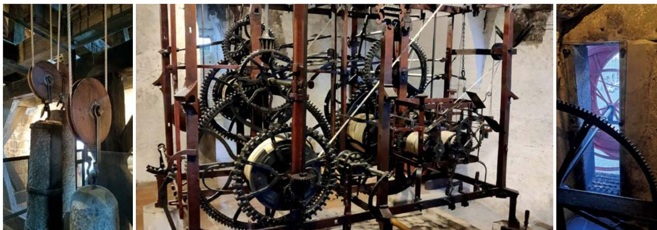
Le mécanisme qui anime la Zytglogge avec, à gauche, les poids qui sont remontés chaque jour et, à droite, la transmission vers l'astrolabe.
