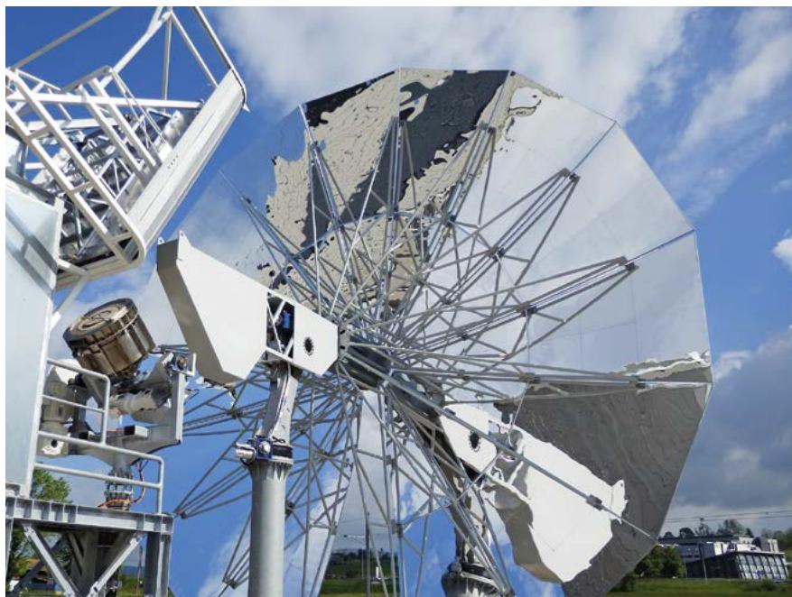
» Concentrateur et réacteur d'un four solaire dans le cadre du projet Interreg « Rasol ».
