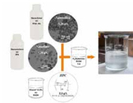
Fig. 2: Mélange ternaire de nanosilice (Nano Estel®) 1,25 g/L, nanocalcite (Nanorestore®) 1,25 g/L et HPC (Klucel® G) 2,5 g/L dans une solution H 2 O:EtOH 1:4. Formulation développée par le CSGI (Consorzio per lo Sviluppo dei Sistemi a Grande Interfase) de l'Université de Florence, d'après Camerini, R. et al., « Hybrid nano-composites for the consolidation of earthen masonry », J. Colloid Interface Sci., 539 (2019), 504–515, adaptée suite à un échange avec D. Chelazzi et L. Borgioli. © MAF/HE-Arc, Bovo Sofia, 2025.
