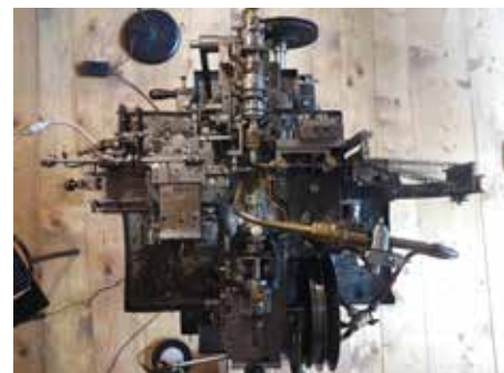
Fig. 3 : Décolleteuse Gilliéron vue d'en haut après traitement. © HE-Arc CR, Santoro Sarah, 2025.
