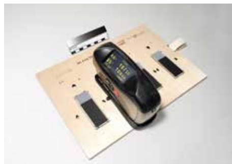
Fig. 1 : Le plateau d'analyse avec le brillancemètre TQC GL0030 monté sur sabot 3D en position pour le relevé de l'unité de brillance d'une lame de microscope. © HE-Arc CR, 2025.
