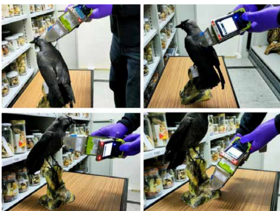
Fig. 2: Analyses XRF d'un spécimen. © Constantin I/K., HE-Arc CR, 2025.
