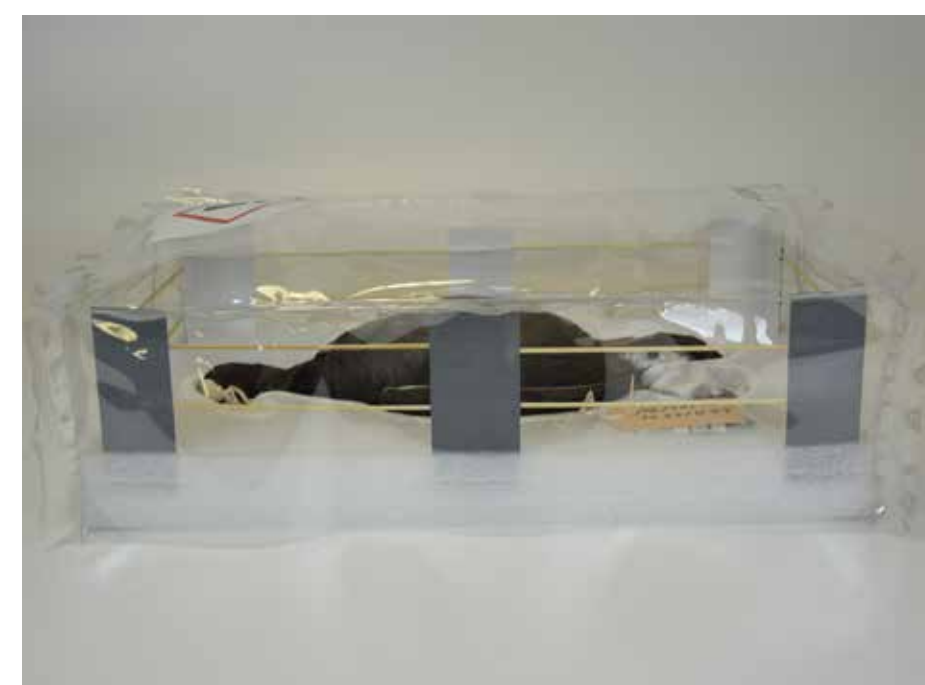
Fig. 3: Conditionnement final de la Foulque Macroule, avec cloche de protection en Mylar®. © HE-Arc, Kaiser L., 2025.
