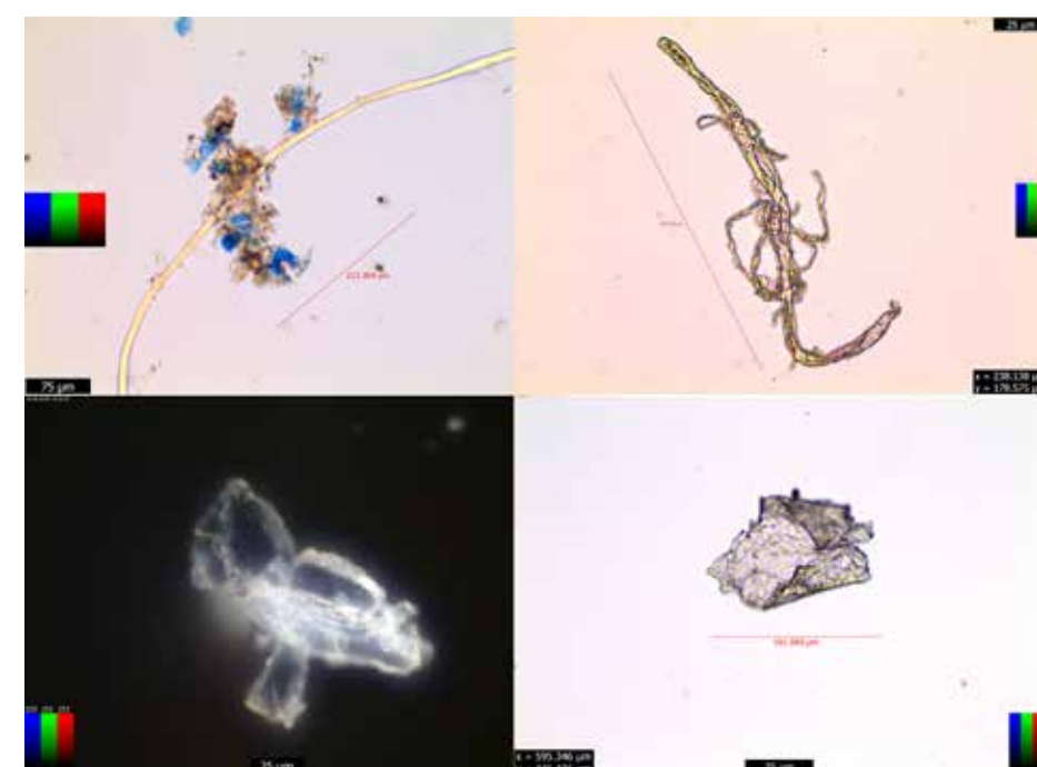
Fig. 3: Poussière teintée au bleu coton. Identification d'une fibre naturelle, d'un agglomérat de particules minérales et d'une particule organique de kératine. Vues en lumière polarisée sous microscope Leica D2900 avec caméra D2700 ©HE-Arc CR, 2025.
