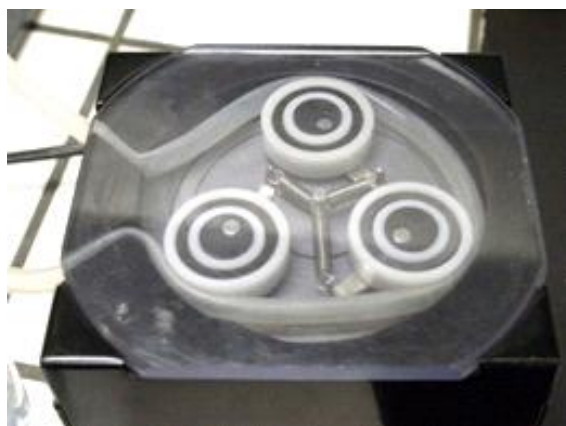
Pompe péristaltique avec système à galets.
