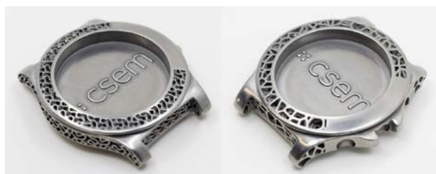
Fig. 3 : Carrures de démonstration en titane produites par fabrication additive
