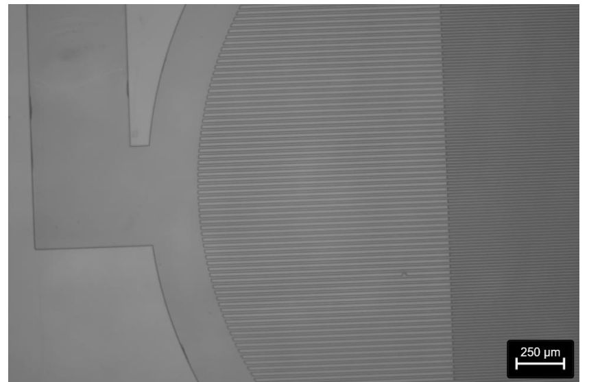
Figure 2 : Vue microscopique des électrodes réalisées après photolithographie (zoom 50x)
