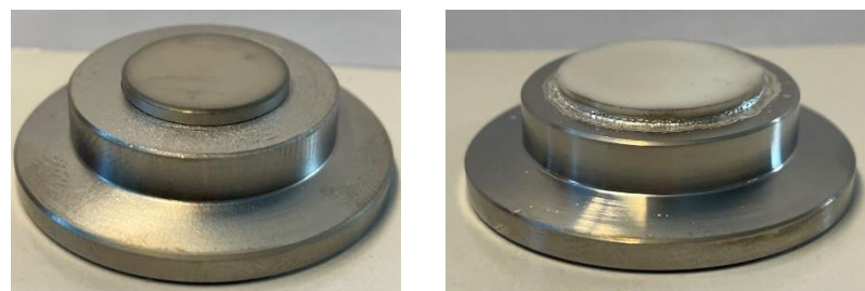
Figure 2 : assemblages brasés obtenus (gauche : or pur, droite : brasure active AgCuTi)
