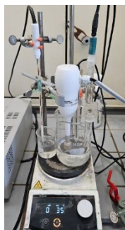
Montage complet avec WE tournante et CE Pt
