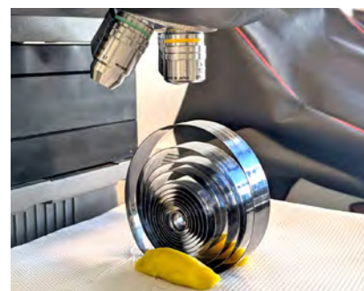
Observation de l'état de conservation d'une pièce d'un mécanisme horloger par analyse profilométrique.
