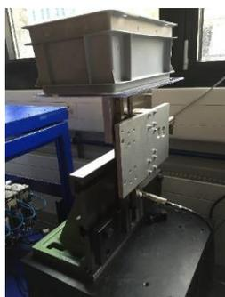
Figure 1: Simulateur de vibration 1
