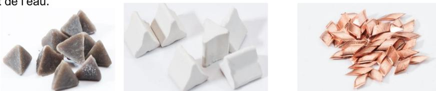
Pour certains passages, il est possible d'ajouter une poudre abrasive qui permet d'améliorer les phases de polissage et de brillantage. Il est également possible d'utiliser dans un milieu sec. Ce procédé applique des mouvements de rotation, de vibration ou encore des mouvements planétaires.
