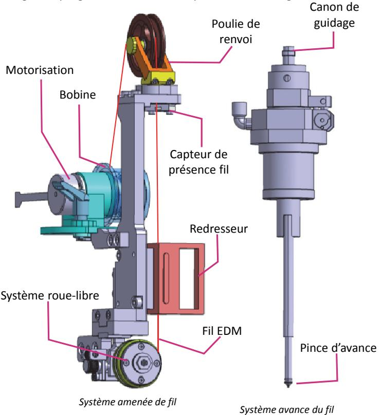
La conception est de façon générale simple. Le système utilise le minimum de pièces possible. Beaucoup d'éléments de fournitures sont présents comme le redresseur de fil, la motorisation Maxon, ou encore le capteur Keyence.
