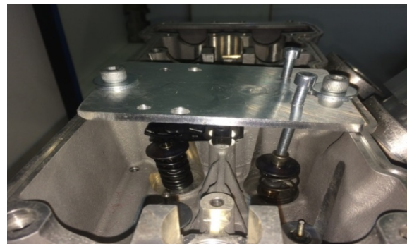
Culasse LMP1 ouverture soupapes
