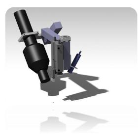
L'outil développé pour ce projet est un ensemble constitué d'un pistolet à air chaud, d'un capteur de température infrarouge, d'un vérin double effet et d'une pince pneumatique. Grace au pistolet à air chaud, on chauffe la LED,
