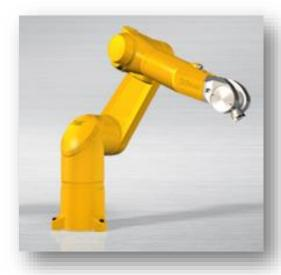
Le robot utilisé ici est un bras articulé avec 6 degrés de liberté lui conférant une grande flexibilité et qui nous offre une enveloppe de travail assez conséquente.
