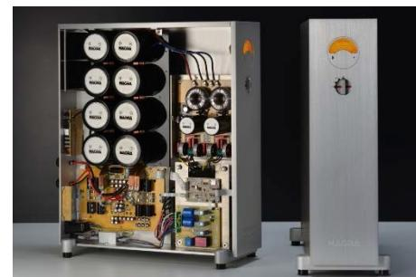
Figure 2 : l'amplificateur HD AMP (ouvert)
