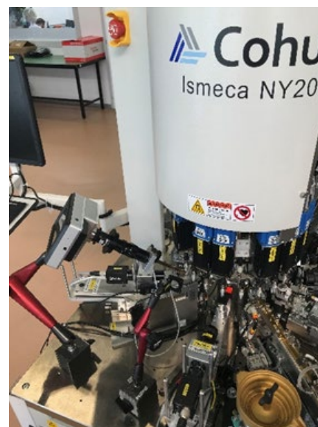
Kit complet incluant caméra, optique, éclairage et supports
