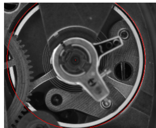
Détermination du centre du balancier
